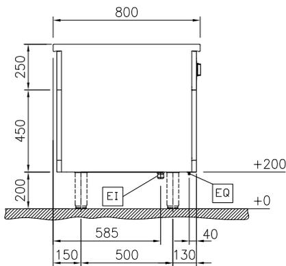
EI = Conexión eléctrica (energía)
